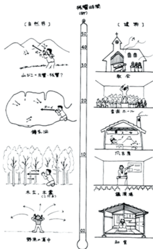
（図－21）残響時間とその例（建築文化1985年版より引用）
