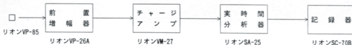
(図-2) 発生音および発生振動測定系の構成図と使用測定器
